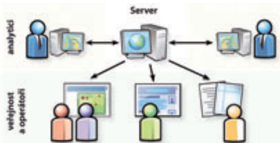
Schéma znázorňuje využití GIS jako poskytovatele informací a jako nástroj pro analýzy. Cesta k operátorům není nutně jednosměrná, protože i oni mají možnost aktualizovat data přímo z terénu.
