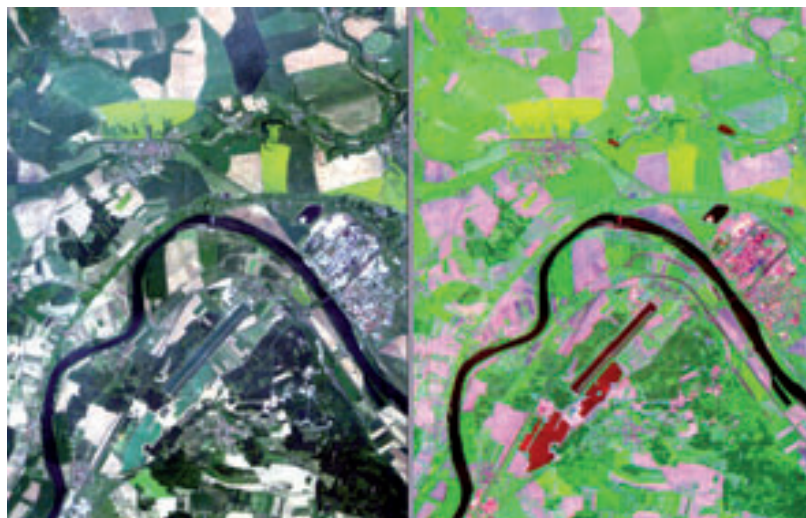
Obr. 2. Ukázka snímku ze senzoru Hyperion – oblast Roudnice nad Labem, kombinace v pravých a nepravých barvách pro zvýraznění dalších informací (© USGS 2002).
