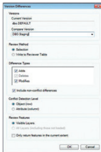
Obr. 5. Nástroj Version Differences identifikuje změny mezi dvěma libovolnými verzemi.
