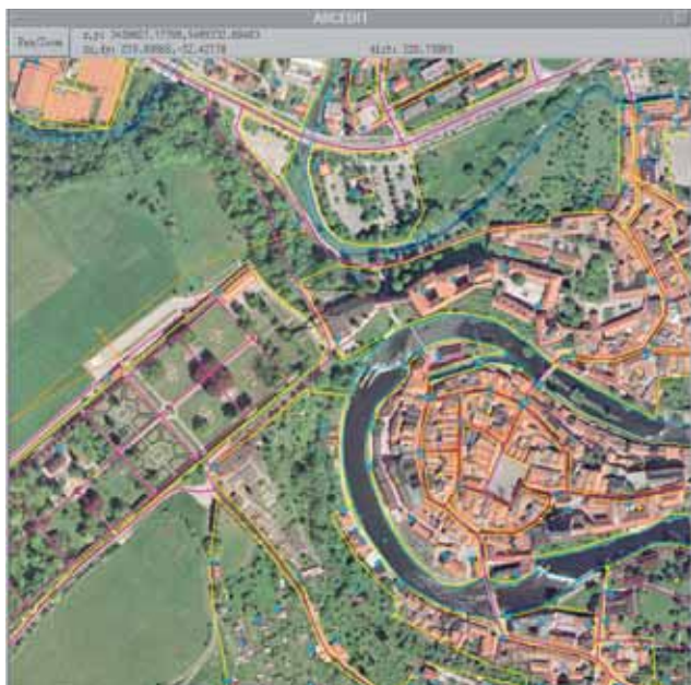
Stereofotogrammetrické vyhodnocení vojenského letiště v prostředí ArcMap (žlutě dráhový systém s přesným vyhodnocením spár, červeně objekty a zařízení letiště, zeleně rostlinstvo, růžově vodorovné značení dráhového systému, oranžově síť pozemních komunikací, bíle oplocení a objekty mimo areál letiště).
