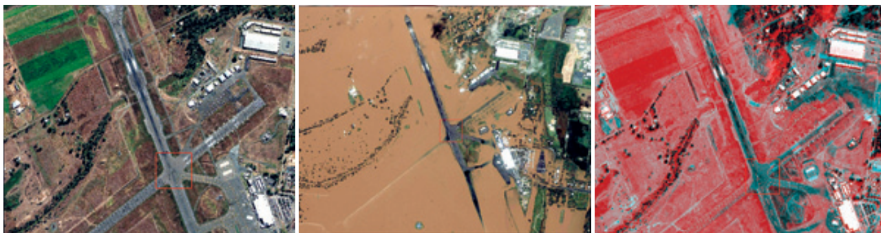
Obr. 3. Snímky z družice IKONOS (před povodní) a Geoeye-1 (během povodně) a detekce změn – změny jsou zobrazeny červeně. Plochu lze exportovat do geodatabáze a změřit rozsah zaplaveného území.
