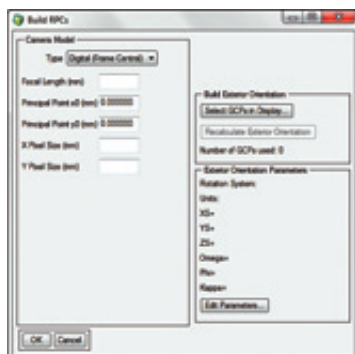
Obr. 1. Výpočet RPC koeficientů.
