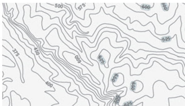
Obr. 16. Ukázka maskování liniové kresby pod popiskem. Vlevo: maskované vrstevnice. Vpravo: polygony masek vytvořené prostřednictvím nástroje Masky obrysu prvku (Feature Outline Masks) z toolboxu Kartografie – Maskovací nástroje.
