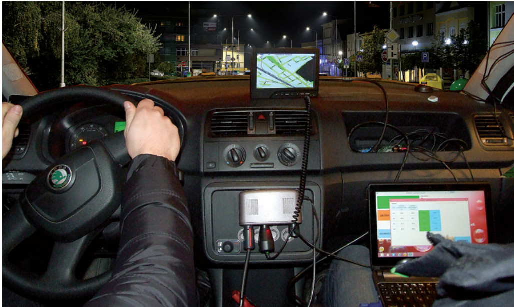
Obr. 4. Mobilní měření osvětlenosti (MOMOK).
