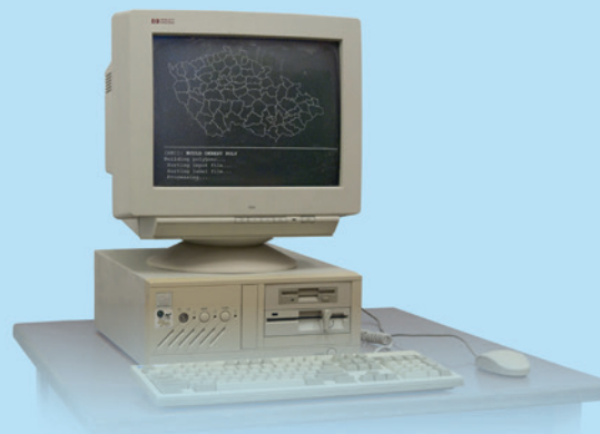
Na počítačích, jako je toto PC AT 486, se pracovalo se softwarem PC ARC/INFO 3.4.
