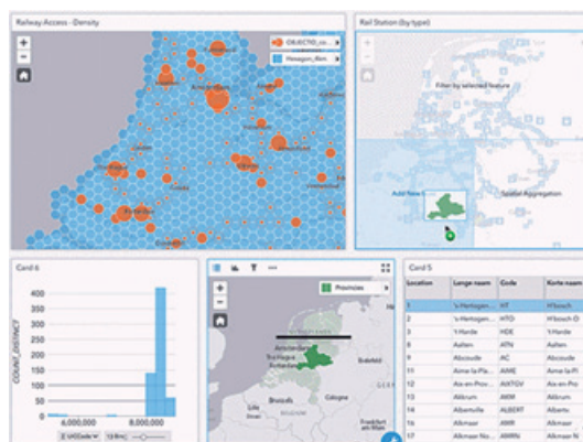
Obr. 6. Pro filtrování dat v Insights for ArcGIS stačí přetáhnout polygonový prvek (sloužící jako filtr) do okna s vrstvou prvků.
