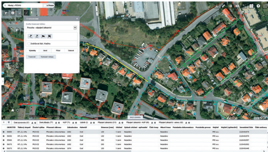
Obr. 5. Ukázka trasování v lehkém klientu za použití bariér s návaznou funkcí připojených zákazníků.
