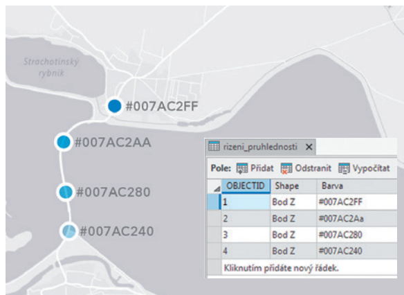
Obr. 6. Změna barvy podle hodnoty atributu včetně průhlednosti.
