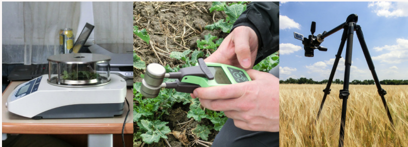
Obr. 1. Ukázka sběru in-situ dat: vážení čerstvé a suché hmotnosti (vlevo), měření obsahu chlorofylu pomocí přístroje Dualex Scientific (uprostřed) a pořizování hemisférických fotografií pro výpočet LAI (vpravo).
