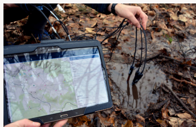
Obr. 2. Collector for ArcGIS jako nástroj pro terénní mapování. V pozadí pracovník drží sondy multimetru pro měření základních fyzikálních charakteristik vody (autor Erik Lehmden).
