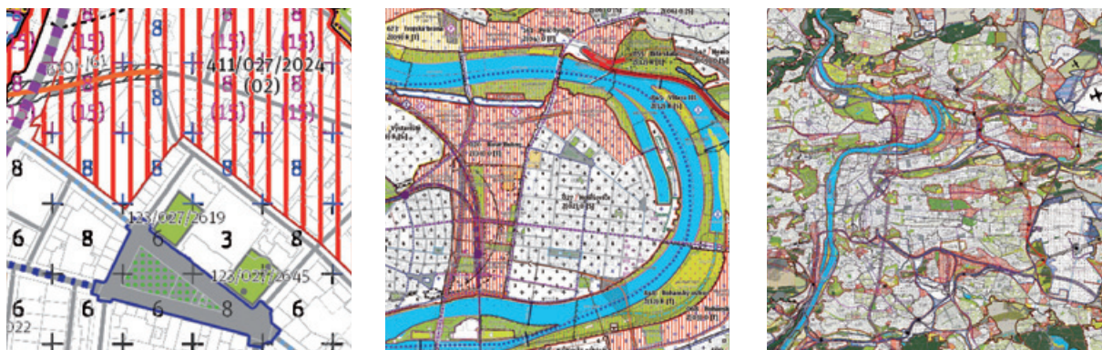
Obr. 1. Postupná generalizace prvků v měřítkách 1 : 10 000, 1 : 50 000 a 1 : 200 000.
