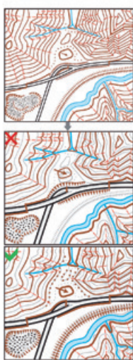
Obr. 7.29 – Generalizace vrstevnic (přívodní data v měřítku 1 : 25 000, generalizované 1 : 50 000 – zvláštní). Správná generalizace vyhledá vrstevnic, zachová charakteristickou strukturu a tvary reliéfu. (upraveno od Bana et al., 2002)
