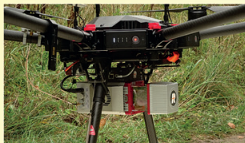
Laserový skener RIEGL miniVUX-1 UAV na dronu DJI Matrice 600 Pro Tento laserový skener umožňuje díky rotačnímu zrcadlu pořízení dat s pravidelným rozložením bodů. Frekvence emulace paprsků je rovna 100 kHz s vytvořením 100 skenovacích linií za vletu s FOV 360°. Skener zachytí paprsek odrážený od objektu vzdáleného 150 až 250 metrů v závislosti na odrazivosti povrchu tohoto objektu a z jednoho paprsku zaznamená až 5 odrážů.
