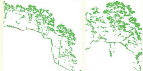
Profily klasifikovaným bodovým mračnem Bodové mračno bylo klasifikováno metodou Standard a následně metodou Aggressive, jak je doporučováno pro členitý terén. Je patrné, že bodů označených jako terén (žlutá barva) je jen velmi málo. Ostatní terénní body buď nebyly klasifikovány nebo byly označeny za vegetaci. Na profilech vpravo jsou viditelné lávky a části skal, na které jsou připojeny.
