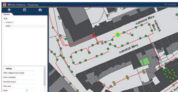
Obr. 3. Aplikaci pasportů využívá i městská policie. Každý sloup veřejného osvětlení má jedinečné evidenční číslo, které mohou strážníci použít jako vodítko k lokalizaci člověka volajícího na tísňovou linku.
