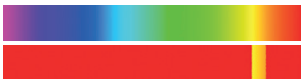
Obr. 4. Červenou barvou je vyznačeno, které části barevné stupnice se při tisku (jinými slovy při převodu z RGB do CMYK) změní.
