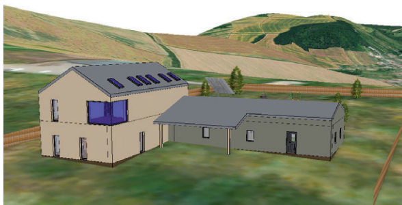
Obr. 3. Model budovy vytvořený v Autodesku Revitu zobrazený v lokální scéně ArcGIS Pro (s pomocí vrstev DMR5G a Ortofoto ČÚZK).
